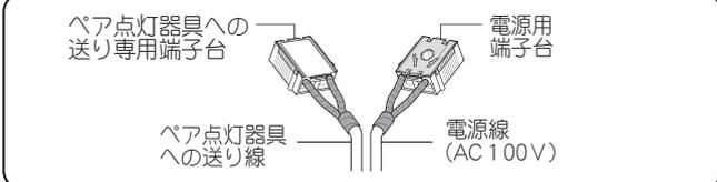
**注意** ペア点灯器具への送り専用端子台に電源線を接続しない。接続する線を間違えると、故障の原因となります。
