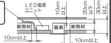
器具は、断熱材・防音材・造営材等と右図のような空間を設けて施工してください。
