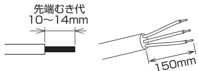
(IV線又はVVVFケーブル2芯 $\phi 1.6$ 、 $\phi 2.0$ を使用する場合など、天井裏の湿気の流入を防止する場合は、付近の空気穴をふさがないようにして器具電源線引込み部の防水処理を確実に行ってください。) 電源電線引込み部の防水性能が保てない状態での使用は火災・感電の原因となります。
