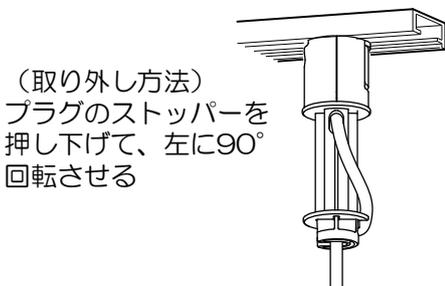
**確認** 取り付け後、ストッパーを下げずに回し、外れないことを確認してください。
