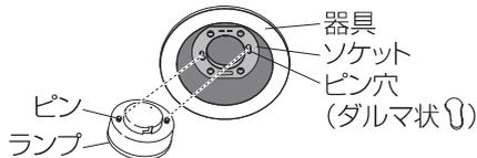
②ランプ回転用ツメ(2ヶ所)を指で押さえ、矢印の方向に確実に回転させる。
