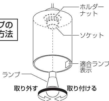
・ホルダーナットが十分に締め付けられていることを確認してください。
