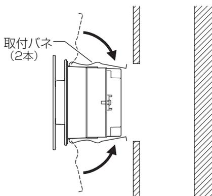
②取付方向表示に従い、端子台の反対側を埋込穴に挿入する。
