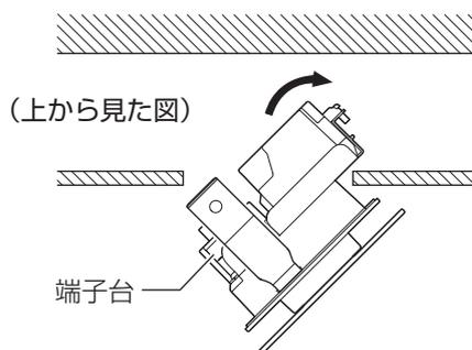
③取付バネの根元を押さえながら本体を埋込穴に押し込む。
