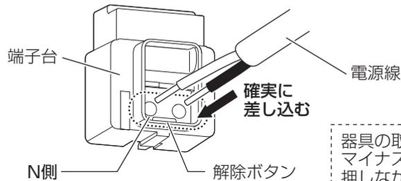
器具の取り替え等で電源線を外す場合は、マイナスドライバー等で解除ボタンを押しながら電源線を引き抜く。
