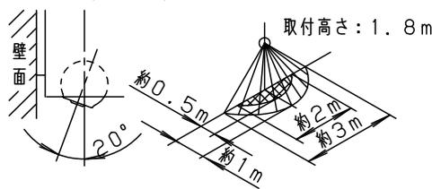
注) ・検知範囲は気温、服装、人の移動速度、進入方向、検知物の熱量、器具の取付高さ、取付面の傾きなどにより変化します。
