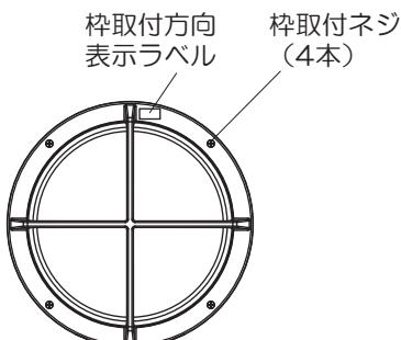
枠取付ネジ（4本）はドライバーを使用し、確実に
