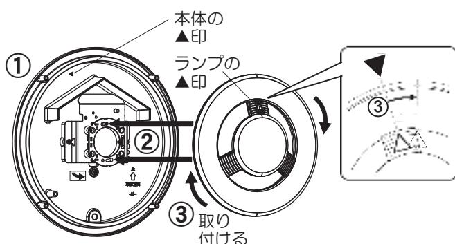
枠にカバーが取り付いていることを確認し、枠取付ネジ（4本）で
