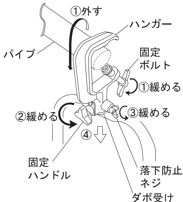
① 固定ボルトを緩め、パイプからハンガーを外して照明器具を床(安定した場所)に置いてください。
