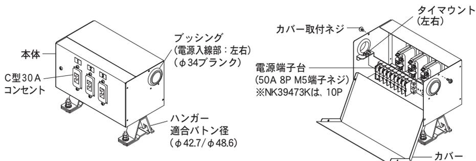
※引き込みケーブルの端子台接続用の丸形圧着端子は別途となります。
