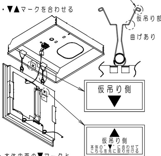
・ 本体内部の▼マークとパネル付点灯ユニット背面の▲マークを合わせて曲げのあるキックパネを本体に引掛けた後コネクタを接続する。
