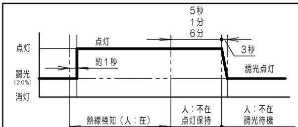
人体などの熱線を検知すると、点灯します。 → 人体などの熱線を検知なくなると、設定時間に合わせ調光します。
