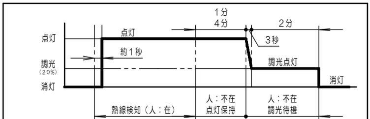
人体などの熱線を検知すると、点灯します。 → 人体などの熱線を検知なくなると、設定時間に合わせ調光(20%)し更に2分後、消灯します。
