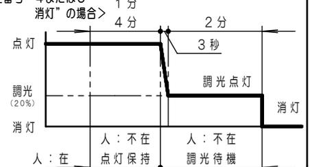
**施工後の動作確認** ～動作モードの設定は、器具出荷状態で、設定番号“1”になっています。～
