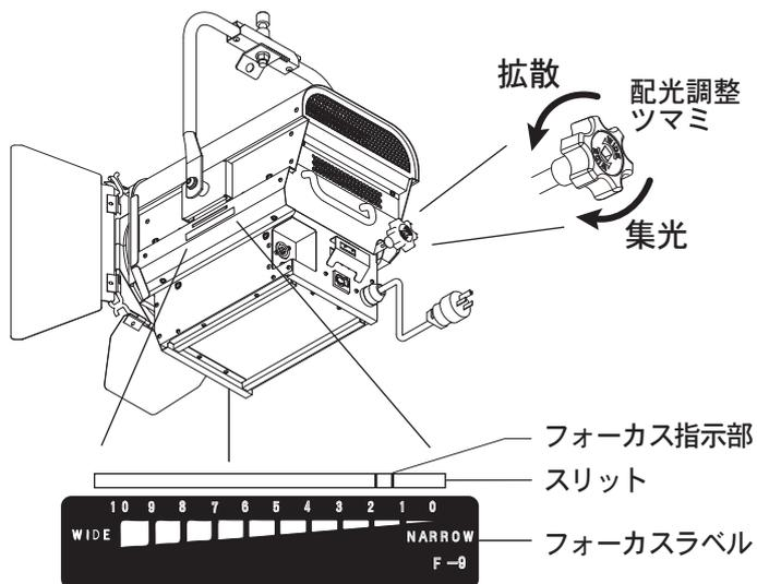
配光の調整は、灯体後部の配光調整ツマミを回転させて行ってください。
