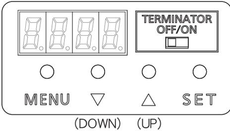
器具の設定変更は、下図を参考にして、MENUスイッチ、UP-DOWNスイッチ(Δ・▽)、SETスイッチ操作によってメニュー内を移動して行ってください。
