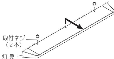
④ 灯具を傾けて、取出穴から虫を器具外に取出す
