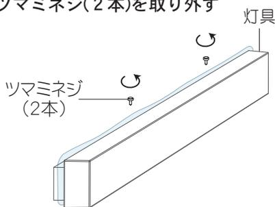
② 必ず灯具のツマミネジ側を左図のように持ち上げて取付板を取り外す。
