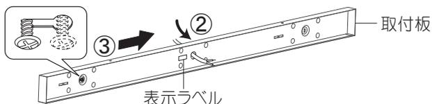
④ 反対側の長穴を木ネジで締め付ける
