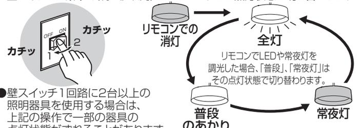
●壁スイッチ1回路に2台以上の照明器具を使用する場合は、上記の操作で一部の器具の点灯状態がずれることがあります。
