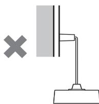
◎この器具は配線ダクト水平天井吊り下げ専用です。
