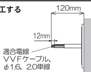
②電源線をフランジ裏面の端子台に差し込む
