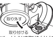
フランジカバーは必ず取り付けて使用してください。フランジカバーを取り外したまま使用すると、水が浸入し、感電・故障の原因となります。
