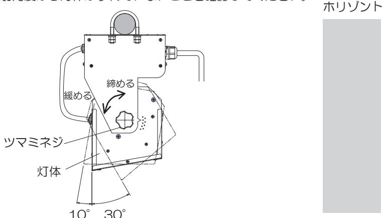
※ツマミネジを軽く緩めた状態で照射角度を調整された場合、
