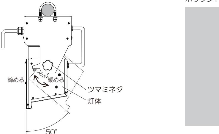
※ツマミネジを軽く緩めた状態で照射角度を調整された場合、
