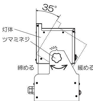
※ツマミネジを軽く緩めた状態で照射角度を調整された場合、
