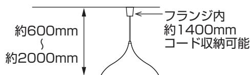
コードハンガーを使用することによって吊り下げ高さをさらに短くすることができます。
