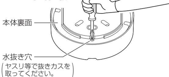
水抜き穴(ヤスリ等で抜きカスを取ってください。)
