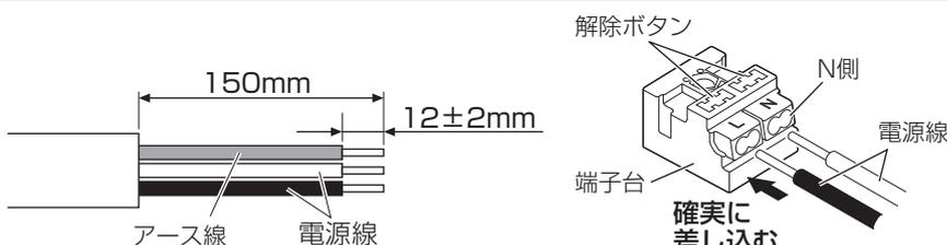
器具の取り替え等で電源線を外す場合は、マイナスドライバー等で解除ボタンを押しながら電源線を引き抜く。
