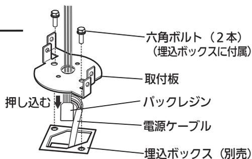
**警告** **!** 取付板を埋込ボックスに取り付ける際、口出し線を傷つけないよう取り付ける必ず守る 感電・ショート・火災のおそれがあります。
