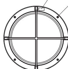
枠取付ネジ（4本）はドライバーを使用し、確実に締め付けてください。
