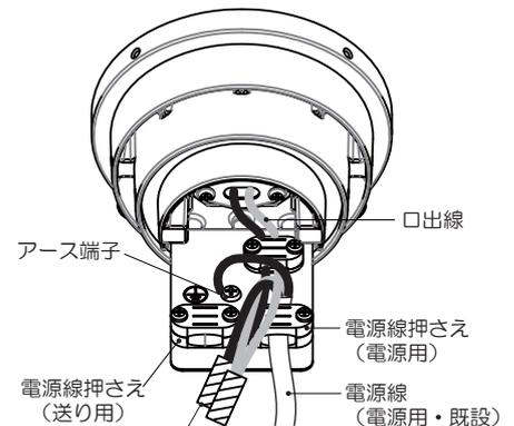
接続部をスリーブなどで結線後、自己融着テープを巻いてから、絶縁テープを巻いて仕上げ、十分に絶縁・防水処理を行ってください。
