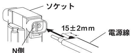
器具の取り替えなどで電源線を外す場合は、マイナスドライバーなどを解除穴に差し込みながら電源線を引き抜く。
