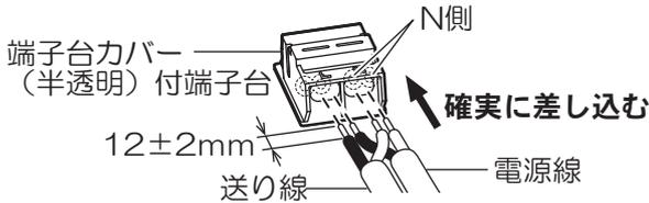
電源線の取り外し方は、マイナスドライバーなどで解除ボタンを押しながら電源線を引き抜く。
