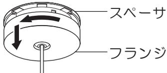
② 取付板から締付ネジと締付リングを取り外す。
