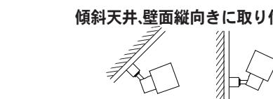
傾斜天井、壁面縦向きに取り付けた配線ダクト
