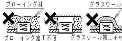
器具は断熱材・防音材・造営材等と下記のような空間を設けて施工してください。
