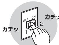
● 壁スイッチ1回路に2台以上の照明器具を使用する場合は、上記の操作で一部の器具の点灯状態がずれることがあります。
