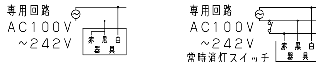
結線図 図1. 常時に消灯しない場合 図2. 常時に消灯する場合
