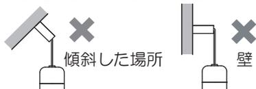
◎この器具は配線ダクト水平天井吊り下げ専用です。
