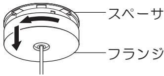
②取付板から締付ネジと締付リングを取り外す。
