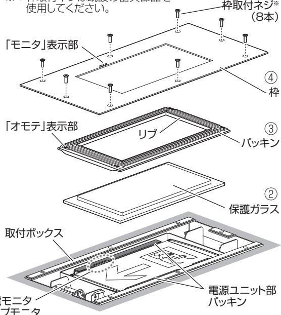
④パッキンのリブが枠の内側から出るように枠をセットする。
