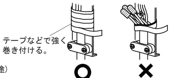
結線処理後、線のかみ込み防止のために、余った線を結線金具にテープなどで固定してください。
