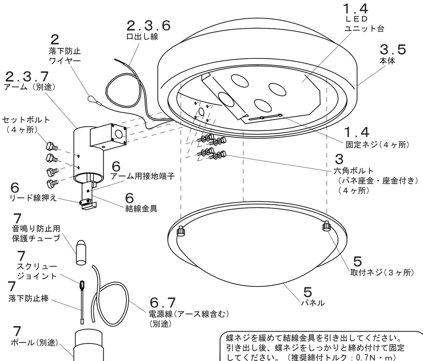
蝶ネジを緩めて結線金具を引き出してください。引き出し後、蝶ネジをしっかりと締め付けて固定してください。(推奨締付トルク: 0.7N・m)
