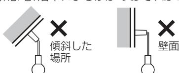
◎この器具は配線ダクト水平天井吊り下げ専用です。
