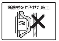
○断熱施工の場合は下図のように 金属スイッチボックスを使用してください。
