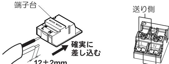
適合電線： $\phi 1.6$ 、 $\phi 2.0$ 単線
