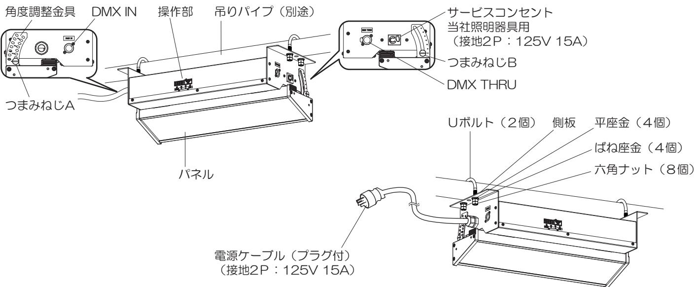
※器具質量に十分耐えるように、吊りパイプの強度を確保してください。
