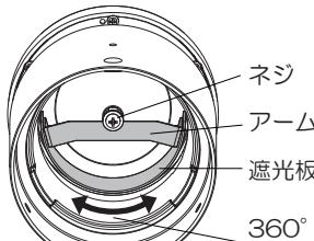
ネジをゆるめて、アームを回し、遮光板を遮光したい位置に調整してください。
