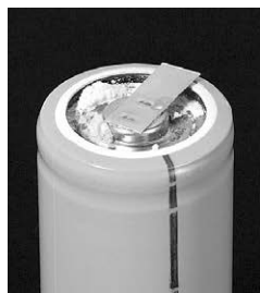
劣化した蓄電池の内部
