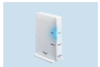
AiSEG2 家電や住宅設備をインターネットにつなげて 連携させる「HOME IoT」の中核機器。
