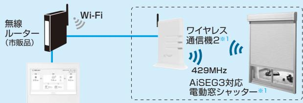
注) ● AiSEG3とWi-Fi通信機2(文化シャッター製)は有線LANで接続してください。
