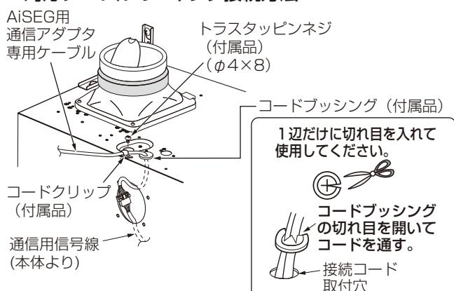
接続が完了したら、接続したコードをファンボックス内部に納め、遮へい板を固定する。
