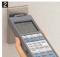
2 スwitchの送受信部にWRT9500Kの受発光部(▲の所)を1cm以内に近づけ動かさない。
