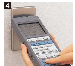
4 グループ3にタイム(遅れ消灯・一時点灯)設定をしたい場合は、 タイム機能選択 キーと タイム キーを押す。 例えば、遅れ消灯5分を設定する場合 遅れ (5分)と押す。
