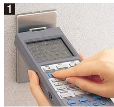
1 スイッチからWRT9500Kをはなす。 機能設定キー(個別)または[G]または[P]または[調光]を押す。 例えば、個別アドレス2-1を入力する場合、 2 - 1 を押す。
