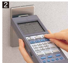
2 WRT9500Kの 設定 を押す。 ※(WRT9500Kより<ピー音>)確認するまで動かさない。(約1~4秒) ↓ アドレス設定完了
