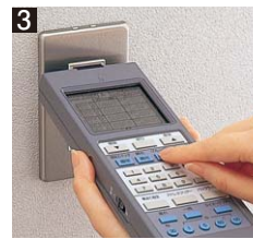
3 3コ目にアドレスが必要な場合 改行 を押す。 例えば、次に[G]3と押す。 ([G]:グループ)
