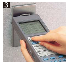
3 WRT9500Kの 確認 を押す。 ※(WRT9500Kより<ピー音>)確認するまで動かさない。(約1~4秒) ↓ アドレス確認完了
