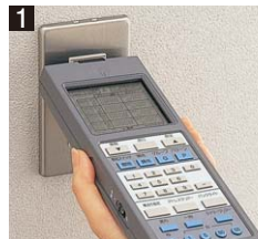
1 スイッチの送受信部にWRT9500Kの受発光部(▲の所)を1cm以内に近づけ動かさない。
