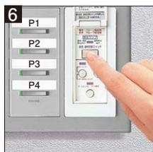
6 設定後、「設定・通常切替」スイッチを押し、「通常」に戻す。(表示ランプ(赤)点灯)
