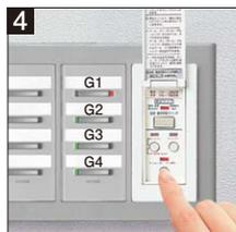
4 初期設定時は必ず「オールエリア外、除外設定用」スイッチを押す。(表示ランプ(赤)点灯) ●選択したグループの内容を消去できます。(確認一部変更の場合4は行わない)
