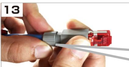
キャップを指で回して、ケーブルを固定する
